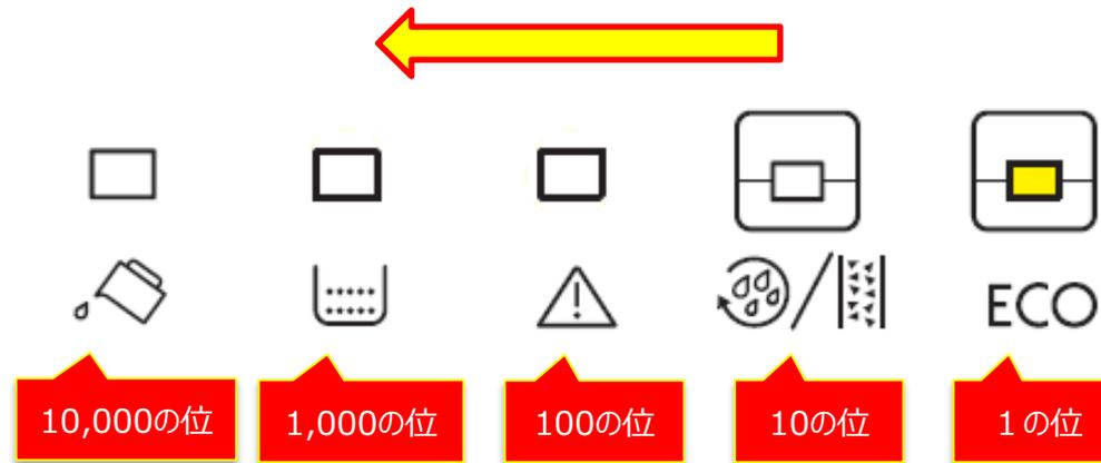
※1/10/100/1,000/10,000の位に対応して、各ランプが点滅します。ランプが点滅した回数を数えることで、抽出杯数をご確認頂けます。
