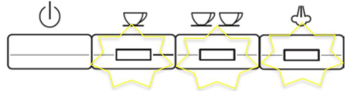
④電源ボタン
