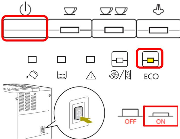
③1杯抽出ランプ、2杯抽出ランプ、スチームランプの3つが2回点滅します
